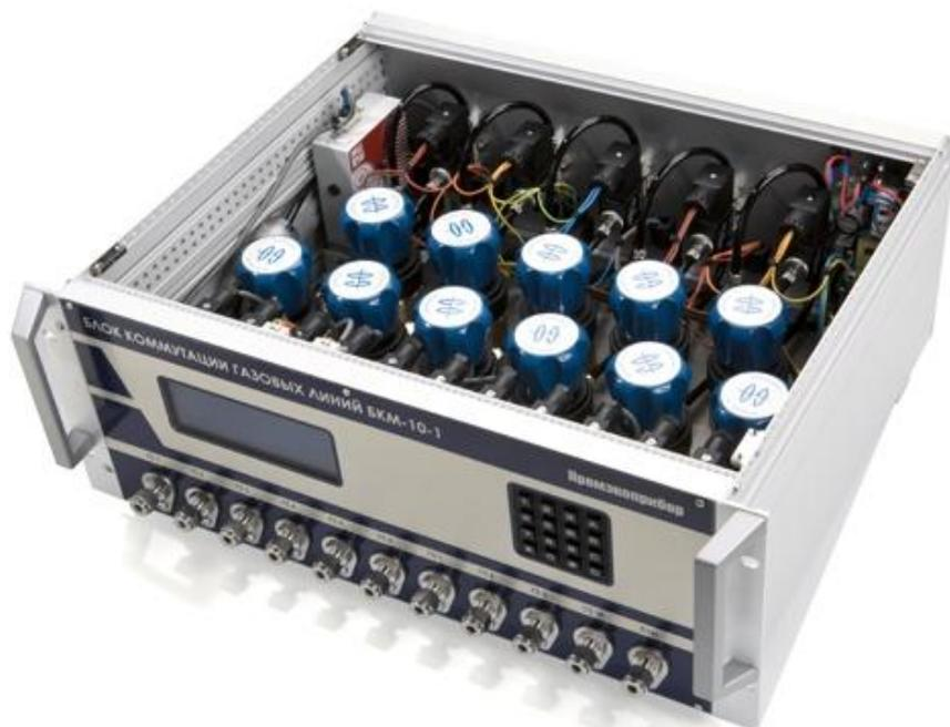
Блок коммутации газовых линий БКМ представляет собой стационарный прибор, выполненный в настольном металлическом корпусе, который может быть установлен в стандартную 19-ти дюймовую приборную стойку.
